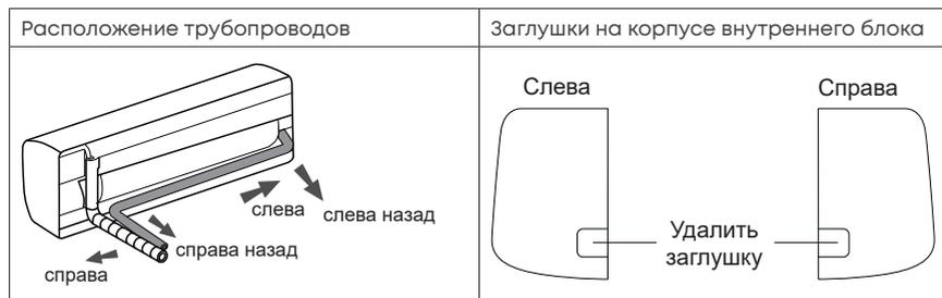
Подключение трубопровода хладагента выполняется после окончания установки внутреннего блока кондиционера. При выборе места установки учитывайте расположение труб холодильного контура, дренажного шланга, проводов, соединяющих внутренний блок с линией питания и наружным блоком.
