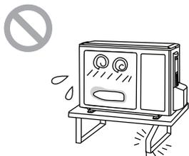
Ненадежно установленный блок может привести к его поломке или нанесению травмы.
