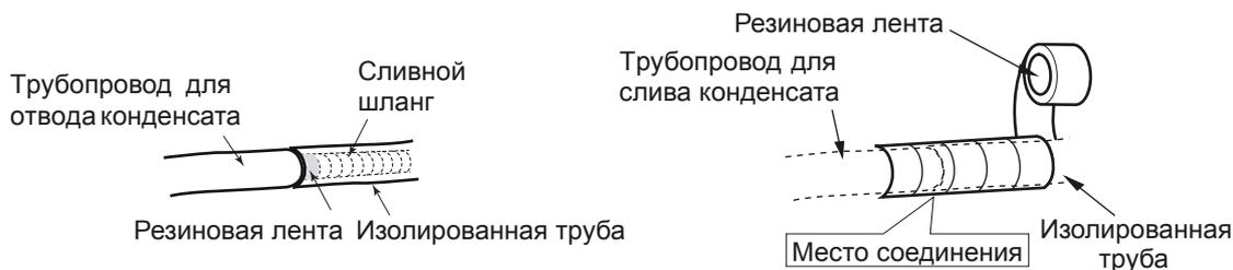
3. Изолированная труба отвода конденсата должна иметь надежное крепление. Не допускаются провисы и подъемы. Следите за тем, чтобы наружный конец трубопровода был свободным, на достаточном расстоянии от препятствий, чтобы обеспечить дальнейший отвод воды.
