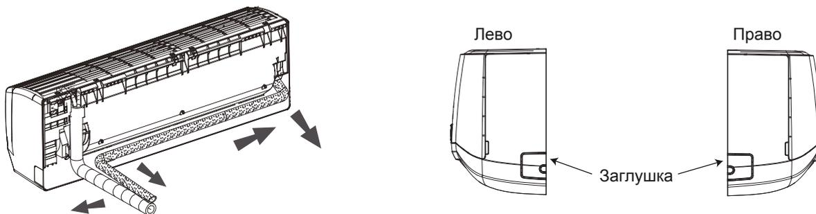
5. Уложите вместе кабель питания, трубу отвода конденсата и фреонопровод, как показано на рисунке, и подайте их через отверстие в стене.
