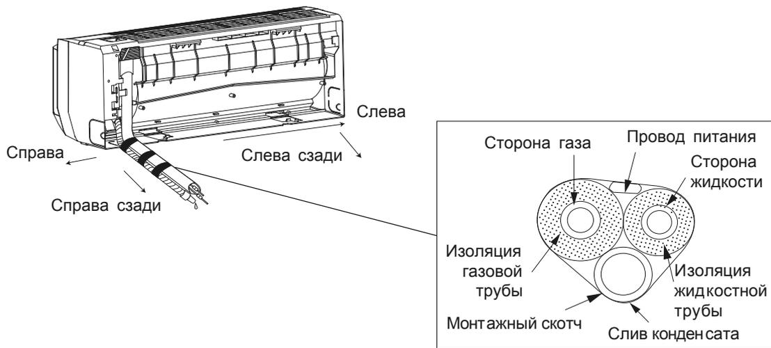
6. Наденьте внутренний блок на специальные кронштейны на монтажной панели. Убедитесь, что они вошли в предназначенные для этого пазы в задней части корпуса блока. Опустите нижнюю часть блока, слегка надавите на блок и прижмите блок к стене, чтобы нижние фиксаторы монтажной панели вошли в зацепление с защелками на корпусе блока.
