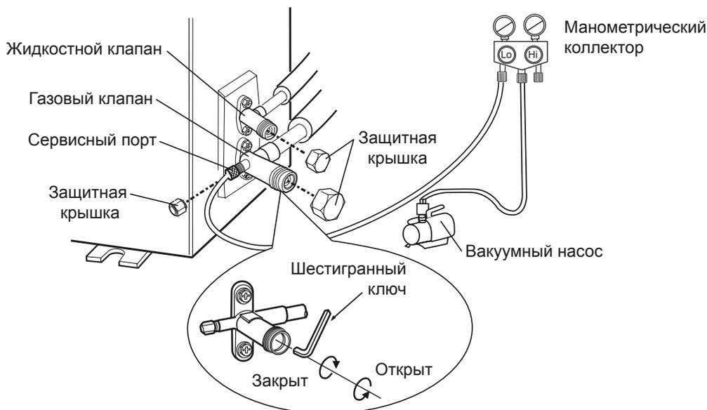
9. Открутите защитные крышки клапанов низкого и высокого давления.
