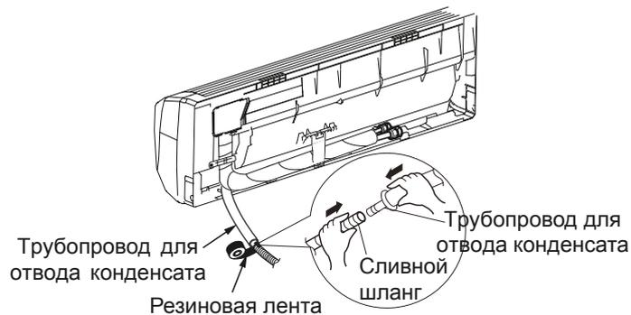
2. Поместите трубопровод отвода конденсата в теплоизоляцию. Обмотайте теплоизоляцию изолентой для предотвращения повреждения и соскальзывания, так как на поверхности неизолированной трубы может образовываться конденсат.
