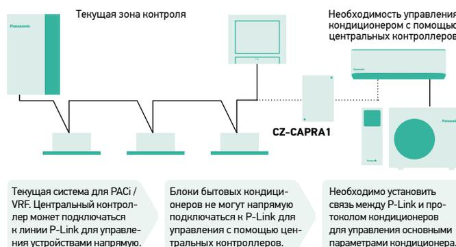
Текущая система для PACi / VRF. Центральный контроллер может подключаться к линии P-Link для управления устройствами напрямую.
